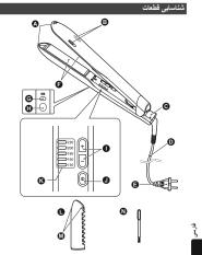
لوازم جاتب*ی* 🕒 حجمدهنده أنكات مربوط حجمدهنده (پرس تمیزکاری (برای خروجی مهن) درباره قال بازایسته قال بازایسته (سطوح سایه خورده) را بامنظور باز کردن یا بستن حرکت دهید. ، در صورت بسته بودن با زور آن را باز نکنید. این کار ممکن است به محصول صدمه بزند.
