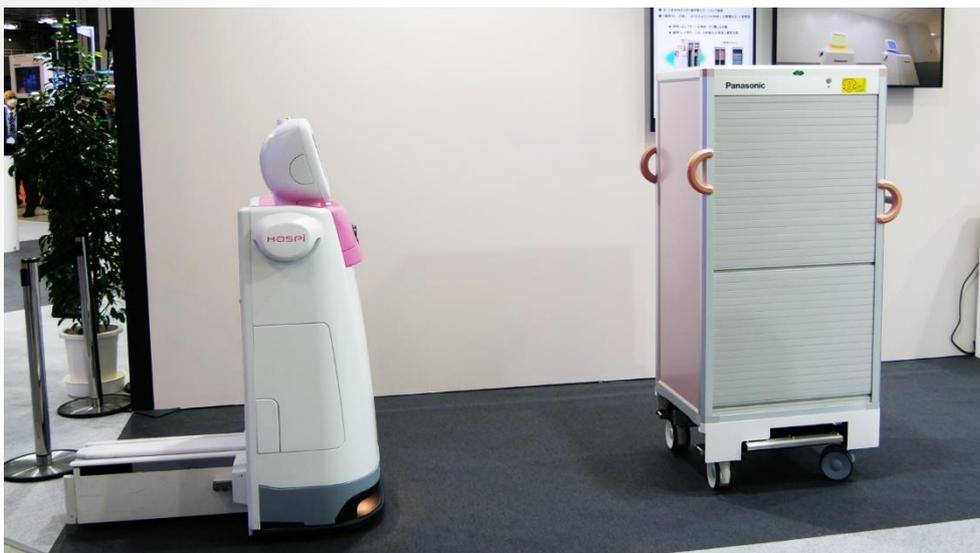
Diseñado para realizar repartos autónomos y paliar la falta de personal en los hospitales, la compañía ha desarrollado HOSPI Trail, la última versión del sistema de reparto robótico autónomo HOSPI, lanzado originalmente en 2013. Desde entonces, estos robots han entregado medicamentos y otros productos en 10 hospitales de Japón y dos de Singapur.
