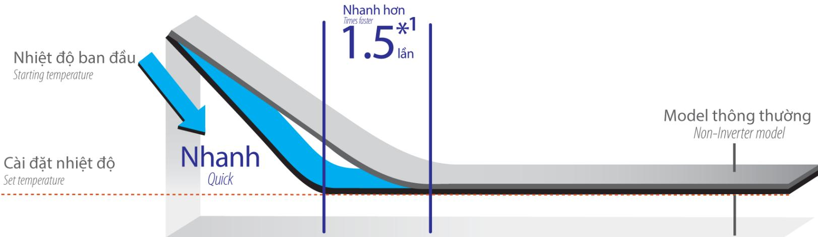
\*<sup>1</sup> Model Inverter 1,5HP so với model thông thường. Nhiệt độ ngoài trời: 35°C; nhiệt độ cài đặt: 25°C
