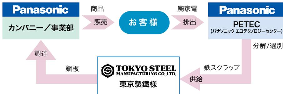
具体的には、PETECで回収された家電製品由来の鉄スクラップを、東京製鐵様の岡山工場に納入し、同工場で電炉鋼板<sup>※1</sup>に加工後、再び当社がそれを調達し製品に活用します。2010年から東京製鐵様と検討を始め、再生鉄の品質を製品に使用できるレベルまで上げたり、加工性を向上させたりするための技術開発を行い、電炉鋼板特性に合った使い方を抽出し、さらに用途ごとに要求される特性(形状や強度、溶接性など)をチューニングして、2011年より電炉鋼板の薄板を製品へ導入してきました。そのような実績を経て2013年、当社資本の家電リサイクル会社から納品された鉄スクラップを電炉鋼板に使用するスキームが実現しました。
