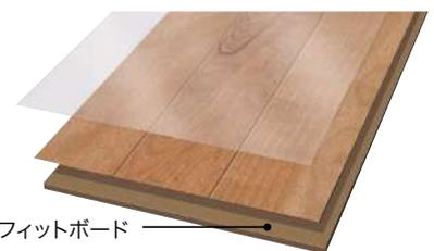
フィットフロアー(耐熱・非耐熱)断面図
