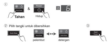
Jika sambungan tersumbat, jalankan fungsi "Pembersihan Mendalam Tangki Auto Dos" untuk membersihkan secara mendalam (masingmasing 47 minit penyelenggaraan untuk detergen dan pelembut).
