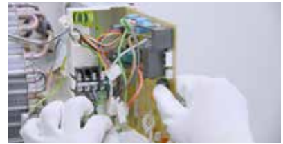
Bo mạch chính rời. Thiết kế không bắt vít giúp dễ dàng tháo bo mạch.
