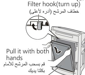
HEPA composite filter Deodorizing filter مرشح الهواء HEPA المركب (مرشح إزالة الروائح الكريهة مغلف في الشبكة السوداء)
