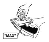
(1) أفتح غطاء تعبئة الماء امسك المكواة على النحو الموضح وأملاها بالماء حتى المستوى "MAX" (حوالي 300 ملي لتر) استخدم كوب نظيف لتعبئة الماء.
