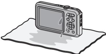
**4 Certifique-se de que não existem gotícula de água, abra a porta lateral e limpe quaisquer gotículas de água ou areia no interior, usando um pano seco. (P133)**
