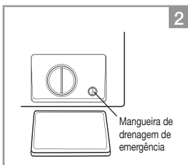
Rode a 90 °C, retire a mangueira de drenagem de emergência e retire a tampa da mangueira
