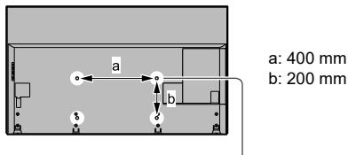
Os orifícios de instalação estão vedados com parafusos de fábrica, é necessária a substituição destes pelos parafusos indicados.
