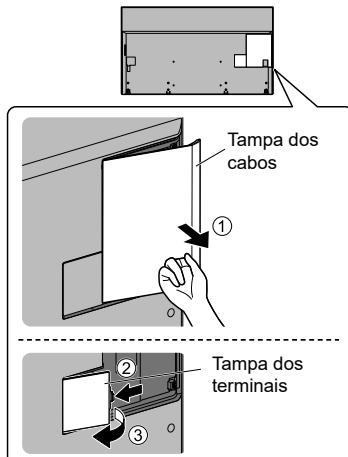
Ao término das conexões, encaixe a tampa conforme desenho a seguir.
