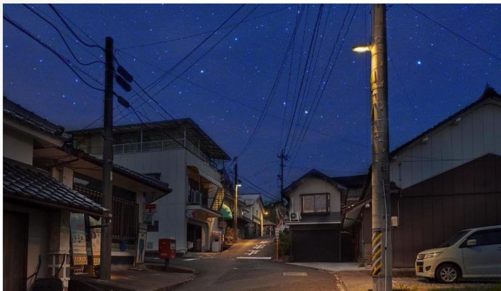
Una via della città illuminata da apparecchi che bloccano l'emissione luminosa verso l'alto e non offuscano il cielo notturno.
