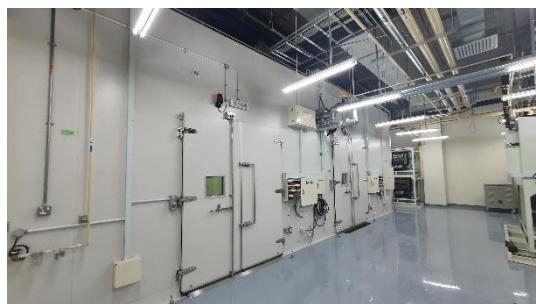
同时测试热水器和空调设备的多功能实验室
