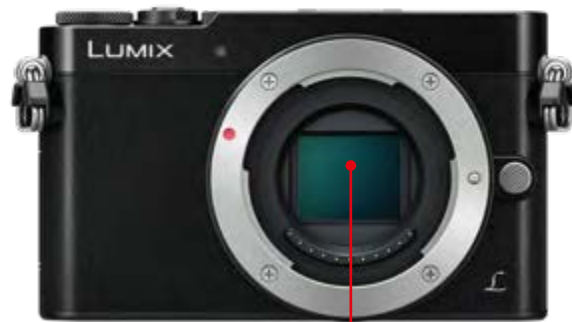
Sensor Micro Cuatro Tercios con 21.3 mm de diámetro
