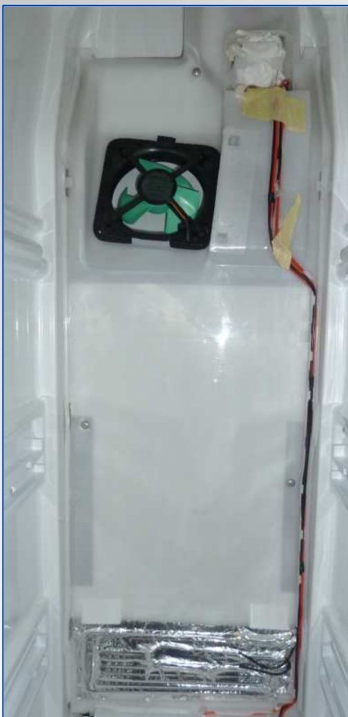
Ventilateur secteur congélateur commande entre 10V et 12V DC
