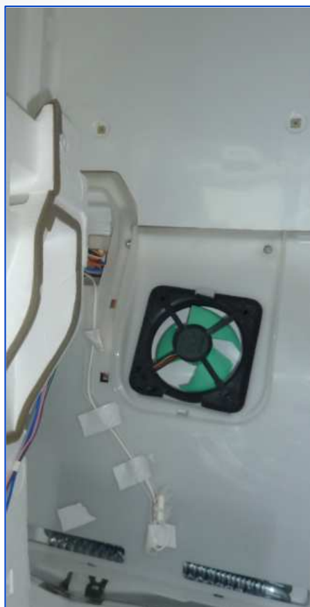
Ventilateur secteur réfrigérateur commande entre 10V et 12V DC
