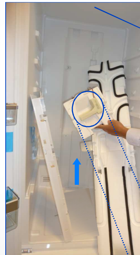
Trappe de circulation d'air
