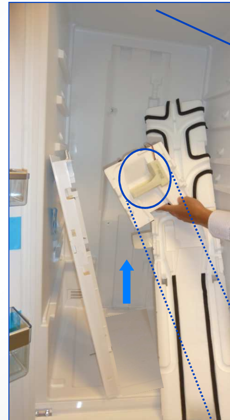
Trappe de circulation d'air
