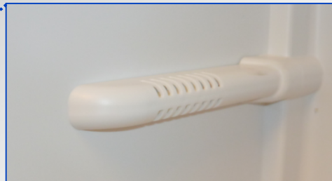
PCC : Sonde de température réfrigérateur
