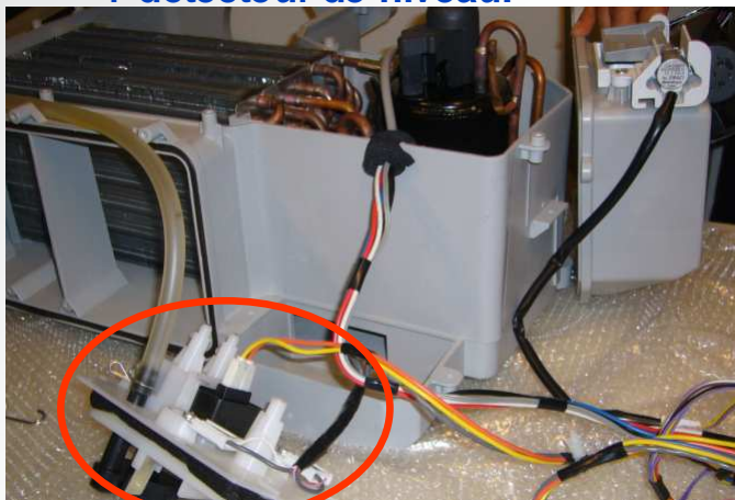
Ensemble pompe de vidange + détecteur de niveau.
