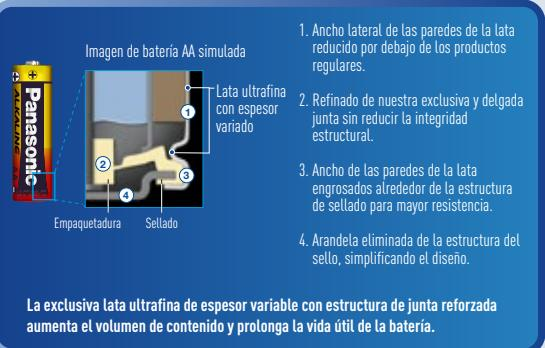
La exclusiva lata ultrafina de espesor variable con estructura de junta reforzada aumenta el volumen de contenido y prolonga la vida útil de la batería.
