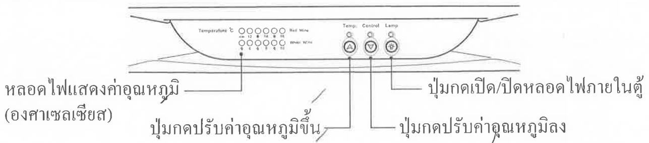
เมื่อเสียบปลั๊กไฟฟ้า หลอดไฟแสดงอุณหภูมิที่หน้าปิดคอนโทรลจะติด 1 ดวง ซึ่งปกติจะติดที่ตำแหน่ง 16 องศาเซลเซียสก่อน หลังจากนั้นประมาณ 3 นาที คอมเพรสเซอร์ก็จะเริ่มทำงาน ตู้แช่ไวน์จะเริ่มทำความเย็นจนกระทั่งถึงอุณหภูมิ 12 องศาเซลเซียส ซึ่งเป็นค่ามาตรฐานที่ได้ตั้งไว้จากผู้ผลิต
