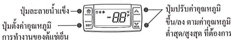
ความหมายของสัญลักษณ์หลอดไฟ LED ที่ตัวควบคุมอุณหภูมิ
