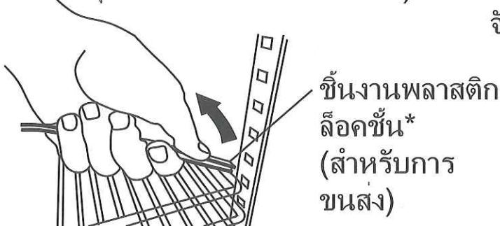
\*ชิ้นงานพลาสติกล็อคขั้นนี้ใช้เพื่อการล็อคขั้นวางของสำหรับการขนส่งเท่านั้น หลังจากที่รื้อออกแล้ว สามารถทิ้งได้
