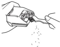
4. Удалите щёткой волоски между неподвижным и рабочим лезвиями, нажимая на рычажок для очистки, который приподнимает рабочее лезвие.
