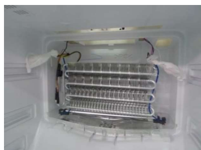
② Kéo hai bó dây điện bên trong xuống, và cắt dây thít
