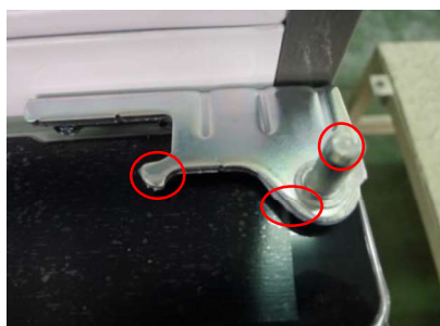
② Dùng đầu tua vít hai cạnh cạy tại vị trí lấy để tháo COVER HINGE TOP
