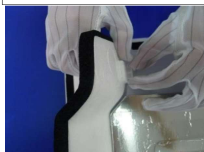
⑥ Ấn vào lẫy như hình để tháo rời INS COVER COIL
