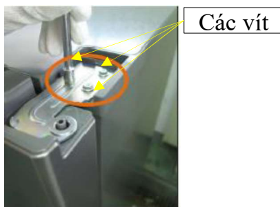
④ Tháo 3 vít để tháo HINGE TOP, sau nhắc PC DOOR ra
