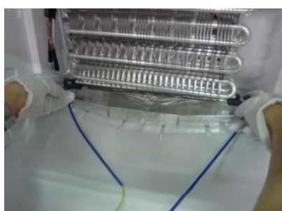
④ Gỡ hai dây điện của DEFROST HEATER rồi nhấc DEFROST HEATER
