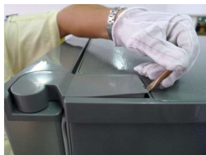
② Dùng đầu tua vít hai cạnh cạy tại vị trí lấy để tháo COVER HINGE TOP
