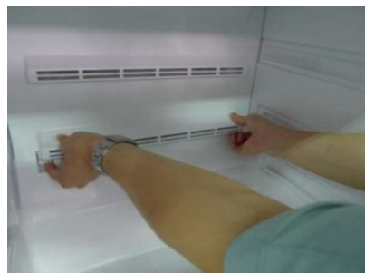
③ Dùng hai tay ấn vào 2 lẫy bên dưới để nhấc COVER COIL AS ra
