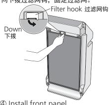
(4) Install front panel. 安装前面板。
