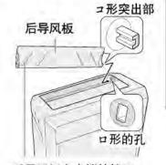
后导风板有支撑的柱子
