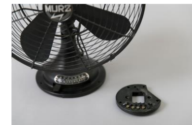
碍盤は、扇風機本体にスイッチを取り付けるための部品(絶縁盤)で、底部に格納されている
