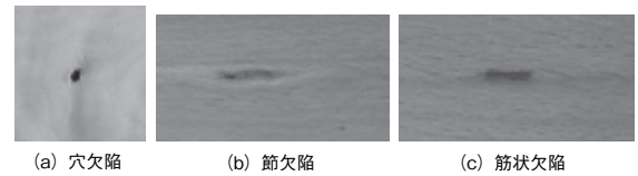
図2 スライス工程の欠陥例
