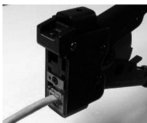
(b) 専用工具を用いた圧接
