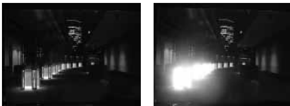
(a) 発光部輝度 135 \text{ cd/m}^2 発光部の大きさ 0.00038 \text{ sr} (b) 発光部輝度 4654 \text{ cd/m}^2 発光部の大きさ 0.0027 \text{ sr}
