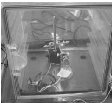
図2 帯電微粒子水による抗原不活化試験 (45 Lチャンバ)
