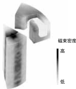
図4 磁界解析による磁束密度分布例
