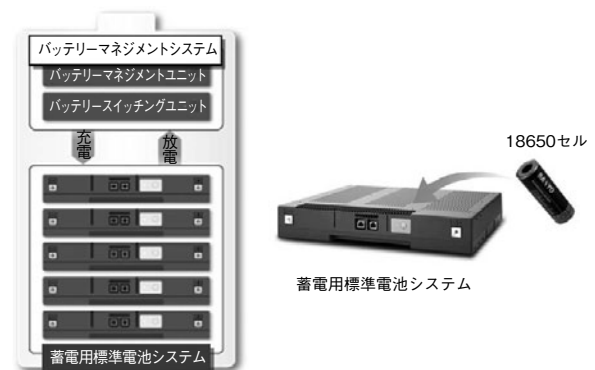
第2図 バッテリーマネジメントシステムとLiBパック
