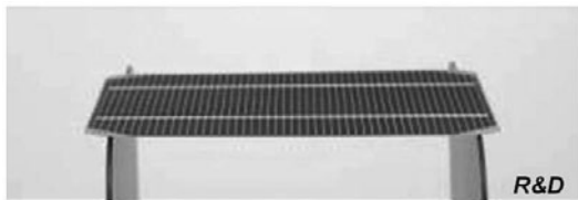
第3図 厚さ58μmのc-SiウエハのHIT太陽電池セルの写真 Fig. 3 Photograph of HIT solar cell with 58-μm-thick c-Si wafer
