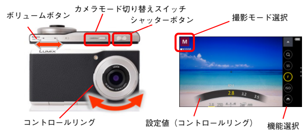
第4図 コントロールリング、キー類と操作画面 Fig. 4 Control ring, key and operation screen
