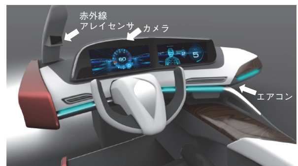
第8図 ドライバーモニタシステムのイメージ図 Fig. 8 Image of driver monitoring system
