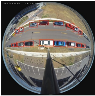
第3図 画像処理PC上の動作画面 Fig. 3 Operation screen of the video analytics PC
