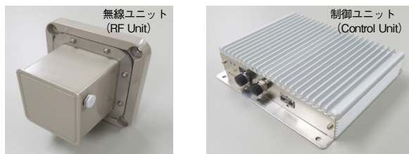
第4図 車車間通信システムの概観(上)とブロック構成図(下) Fig. 4 Picture of wireless inter-carriage system and block diagram
