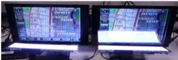
開発品 (正反射 0.4%) 未対策品 (正反射 15.5%)
