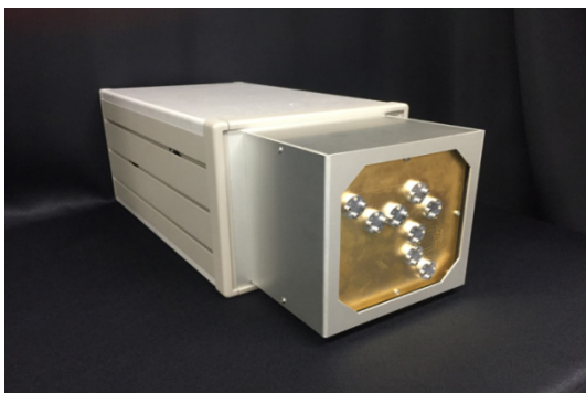
第3図 スペクトラム拡散レーダ試作機の写真 Fig. 3 Photo of the spread spectrum radar prototype
